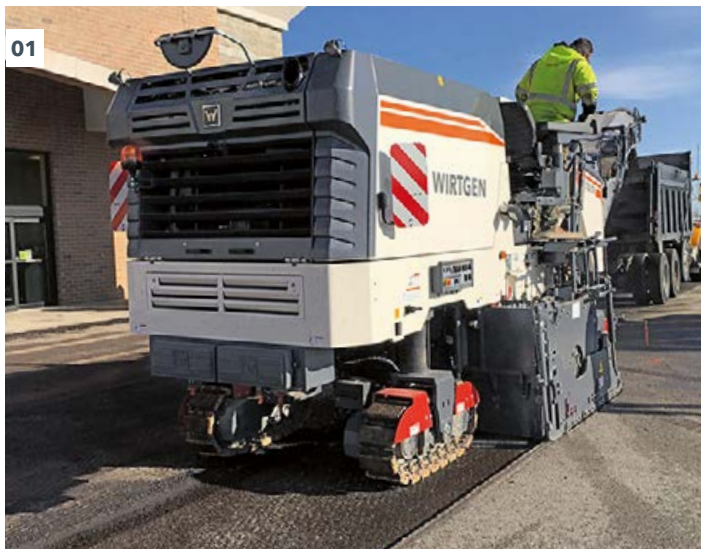
01 Die W 150 CFi mit einer 1,8 m breiten Fräswalze sorgt für erhöhte Tagesleistung.
